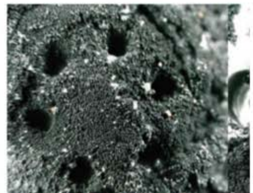
Rußablagerungen an der Einspritzdüse eines Motors.
